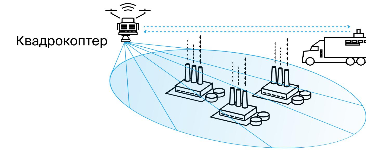
Машина с установленным Лидаром движивает движение квадрокоптера. Машина движется или стационарно находится в одной точке, квадрокоптер движется по заданной траектории и таким образом производится замер выбросов в объеме.
