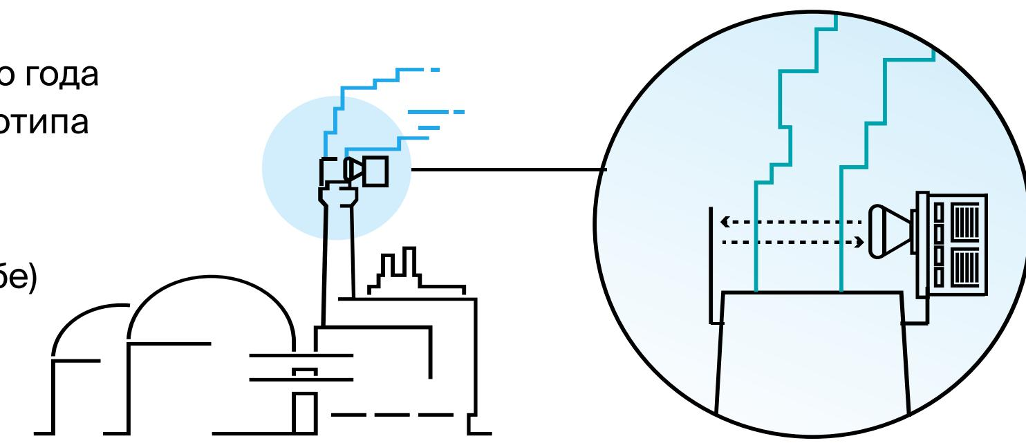
Инструментальные замеры выбросов углеродных единиц (в кг) и загрязняющих газов прибором, устанавливаемом на трубе.
