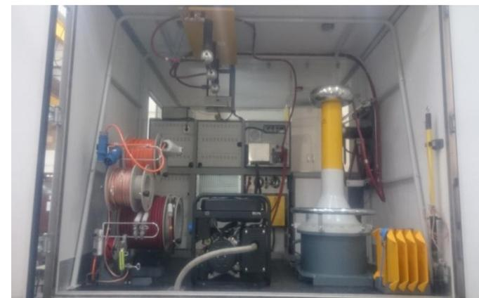
Передвижная высоковольтная поверочная лаборатория ВПЛ предназначена для организации работ по первичной и периодической поверке высоковольтных измерительных трансформаторов тока (ТТ) и трансформаторов напряжения (ТН) на месте их непосредственной эксплуатации. Современное оборудование, входящее в состав лаборатории ВПЛ, позволяет осуществлять широкий вид работ.
