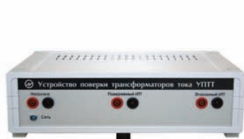
УПТТ (устройство проверки трансформаторов тока)
