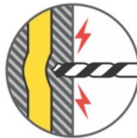
Механическое повреждение изоляции
