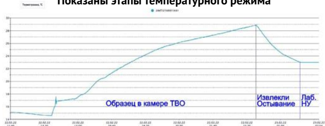
Термограмма датчика в образце. Показаны этапы температурного режима
